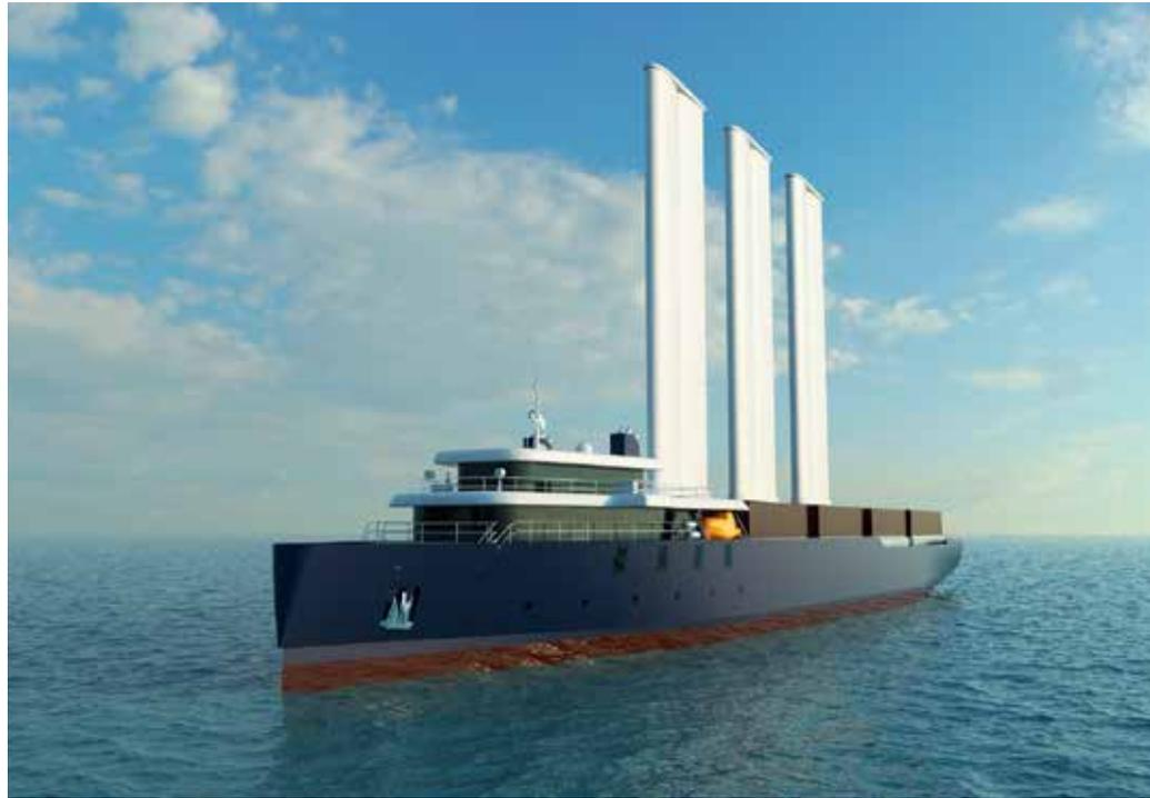
Zéphyr & Borée propose un cargo mu par des voiles rigides et consommant 30% d'énergie fossile en moins.
